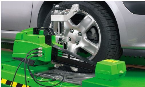
Fig. 19: Posicionamiento de los registradores de valores de medición
