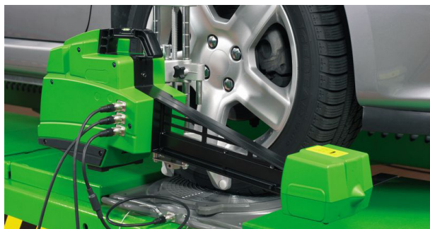
Fig. 19: Posicionamento dos sensores de medição, à frente
