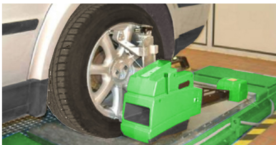
Fig. 20: Umieszczenie głowic pomiarowych z tyłu
