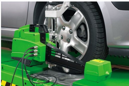
Fig. 19: Umieszczenie głowic pomiarowych z przodu
