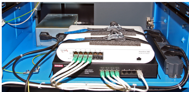
Fig. 1: Collegamento connessioni LAN
