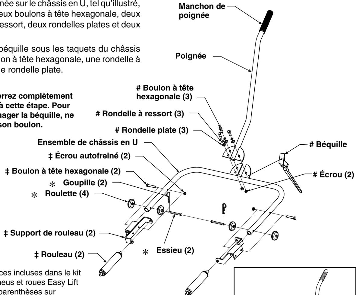
Le nombre de pièces incluses dans le kit de chariot pour pneus et roues Easy Lift est indiqué entre parenthèses sur l'illustration. Les pièces dont le nombre n'est pas indiqué sont en quantité simple.
