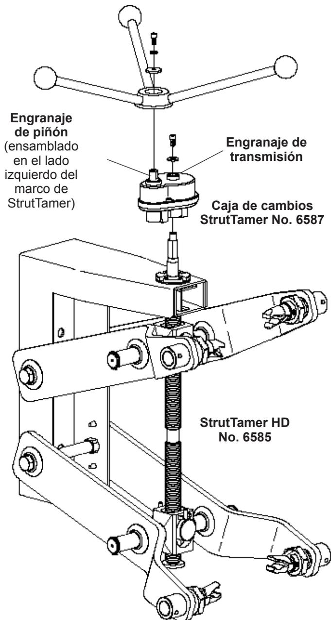
1. Retire el tornillo de tapa, arandela de seguridad, arandela, espaciador y manija de la parte superior de StrutTamer. Deseche el espaciador.
