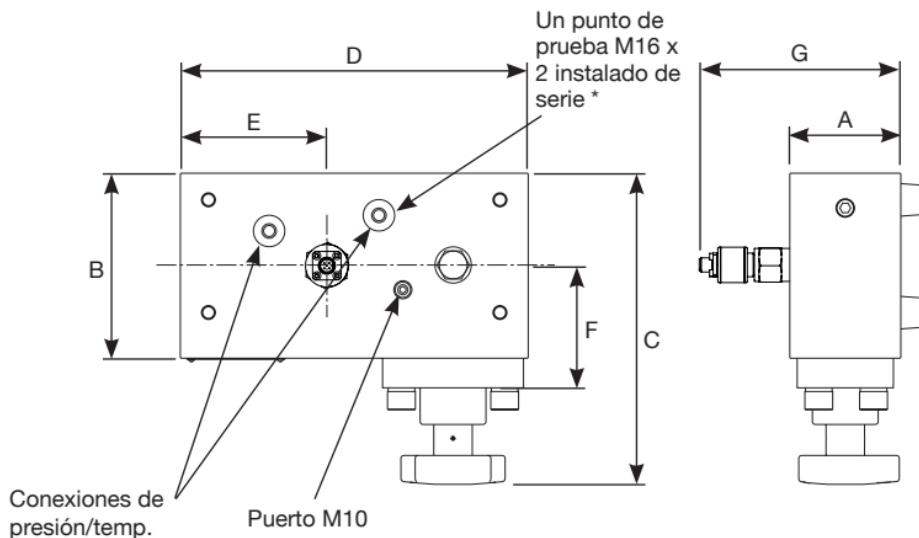
\* Puerto conectado mediante válvula de vaivén para garantizar que se mide la presión máxima cualquiera que sea el sentido de flujo.
