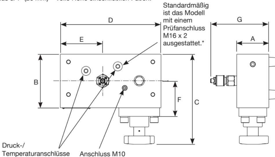
Standardmäßig ist das Modell mit einem Prüfanschluss M16 x 2 ausgestattet.\*
