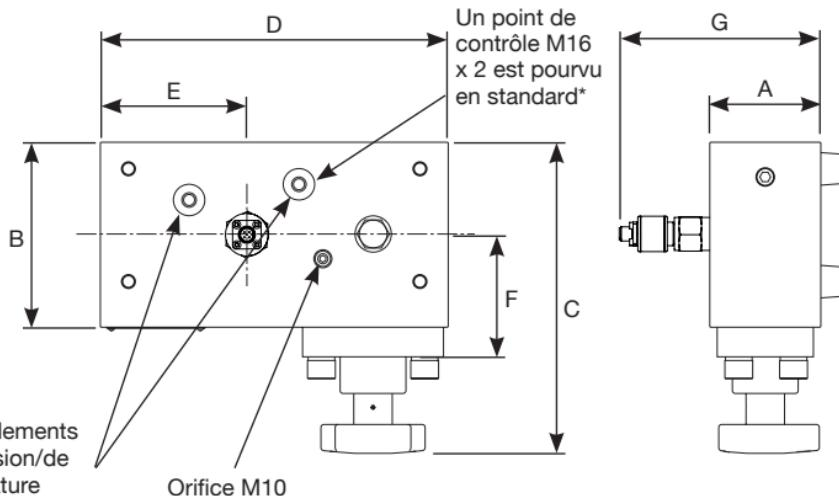
\* Orifice raccordé par l'intermédiaire d'un sélecteur de circuit afin de garantir que la pression maximale est mesurée quelle que soit la direction de l'écoulement.
