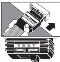
Ahora, la computadora del motor está en el «Modo de Diagnóstico en el campo». La lámpara «Check Engine» (Rvise el Motor) indica cómo está funcionando el sistema de control de combustible. Vea adelante.
