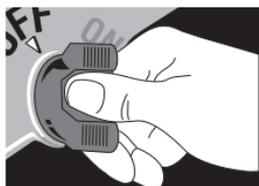
6) Enchufe el Lector de Códigos en el Conector de Pruebas. Coloque la llave para pruebas en ENGINE (motor).
