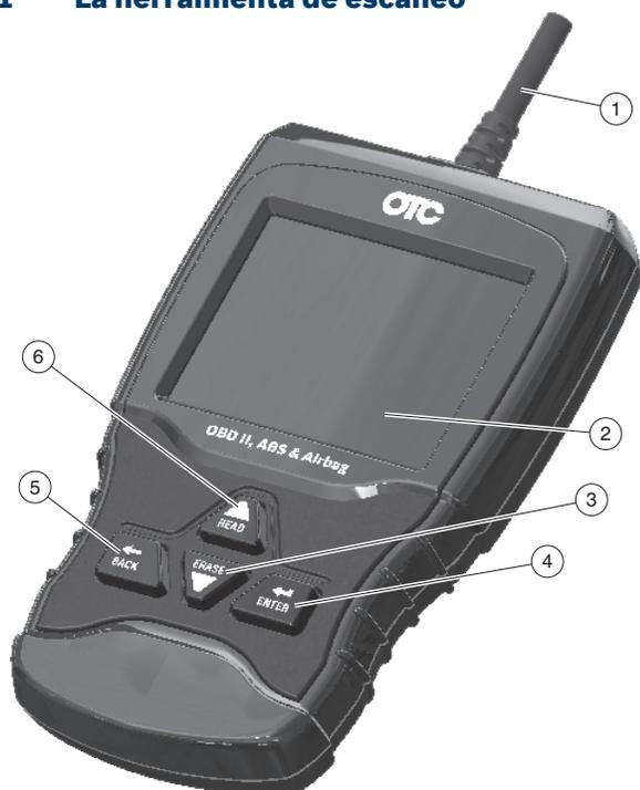
1. El cable del DLC proporciona la conexión para la interfaz del vehículo.
