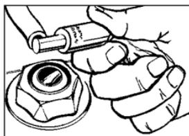
Retirez du bouchon de reniflard du couvercle des soupapes la vanne de recyclage des vapeurs d'huile. Assurez-vous de remettre la vanne de recyclage des vapeurs d'huile en place une fois que le contrôle et les réparations sont terminés.
