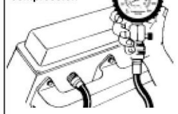
7. Insérer le tuyau dans le manomètre en tirant vers le haut sur le manchon extérieur de l'accouplement à déconnexion rapide du manomètre et le laisser se refermer lorsque le raccord s'engage dans l'accouplement.
