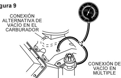
Si el vacuómetro no cambia o lo hace muy poco al cambiar la rpm como se describe anteriormente, la manguera de vacío podría estar abierta o agrietada, o el diafragma en el mecanismo de avance podría estar perforado.
