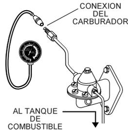
**NOTA:** La línea de combustible en el tazón del carburador será suficiente para hacer funcionar el motor durante estas pruebas.
